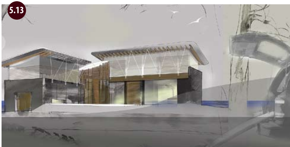
Daudzdzīvokļu mājas pārbūve par dzīvojamo (5.13. att.). Izmantojot esošo pamatu konfigurāciju, daudzdzīvokļu mājas vietā projektēta neliela savrupmāja.
