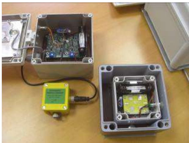
26. attēls. Atvērts skaitītāja RBX5 L raidītājs, uztvērējs un datu glabātājs (dzeltenā krāsā)
