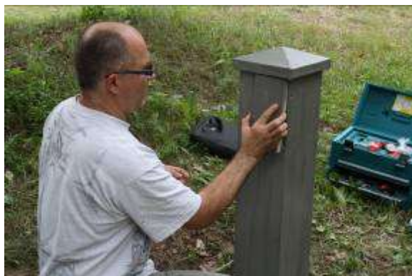
29. attēls. Elektroniskais skaitītājs ir iestrādāts stabā, kas imitē aizsargbarjeru
